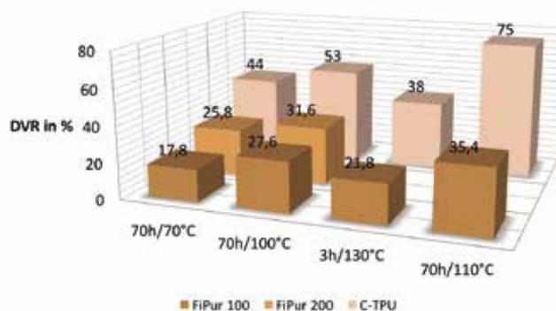
»4 Druckverformungsrest bei Extremtemperaturen im Vergleich zur handelsüblichen Qualität (C-TPU) (Bild: Fietz Automotive GmbH)
